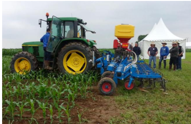
Démonstration de la bineuse équipée des systèmes Econet et Precicam
