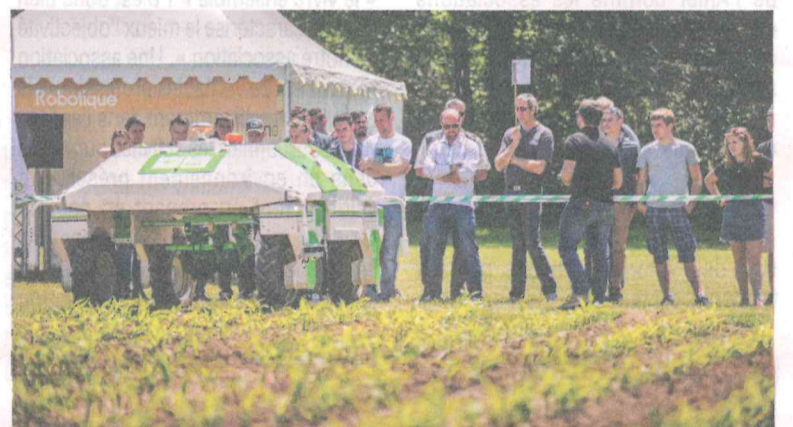
Démonstration de binage de maïs par le robot Dino de la société Naïo Technologies.
